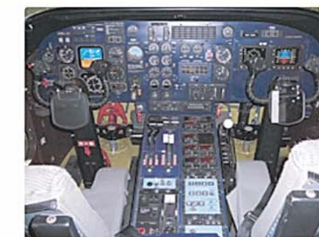
右側がフライ・バイ・ワイヤ操縦席 水色のパネルはフライ・バイ・ワイヤ操縦システム用スイッチ Right seat is used for fly-by-wire control. The switches for fly-by-wire control system are on the light blue panels.
