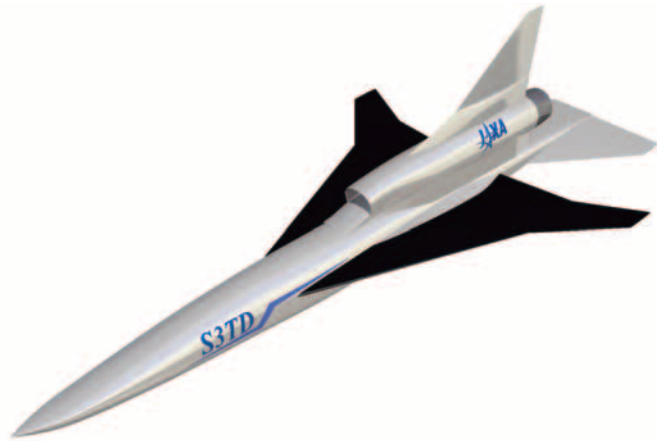
低ソニックブーム実証用の静粛超音速研究機 Silent supersonic technology demonstrator
