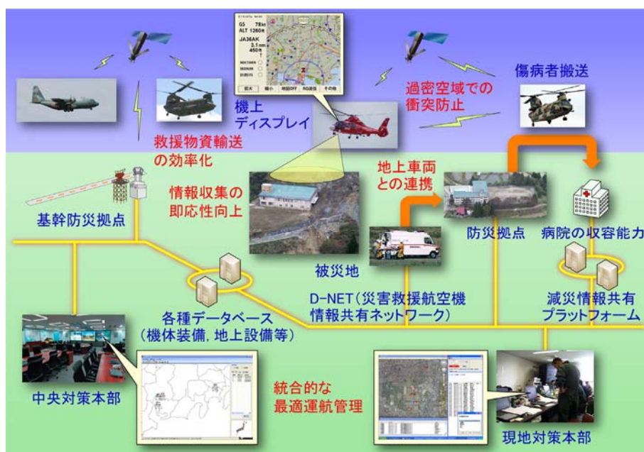
図1 大規模災害を想定したヘリコプタの情報共有と運航管理システムの概念図
