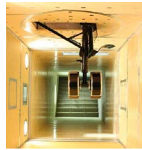
図 4 風洞試験による降着装置騒音の計測
