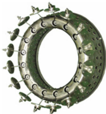
図6 リッチリーン燃焼方式の環状燃焼器
