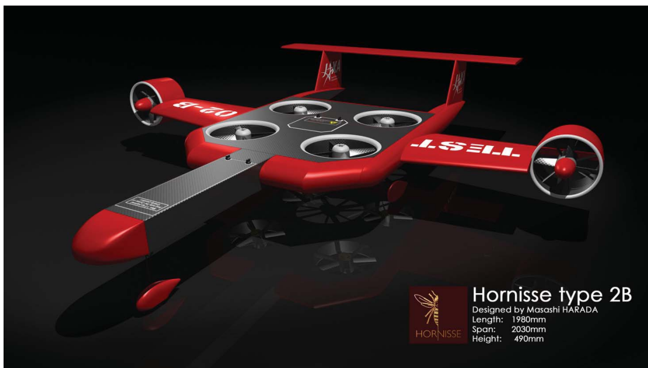
図5 2mクラスVTOL試験機俯瞰図（CGイメージ）
