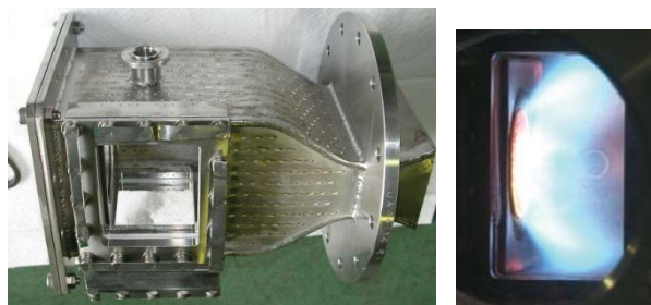
図3 可視化用燃焼器(左)と燃焼状態の一例(右)
