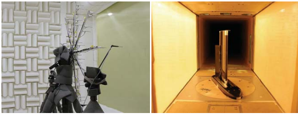
図3 無響室マイクアレイと高揚力装置付き翼模型
