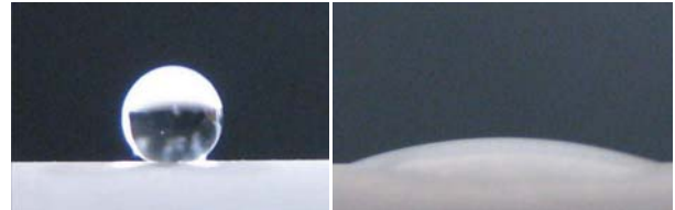
図5 疎水性表面(左図)と親水性表面(右図)
