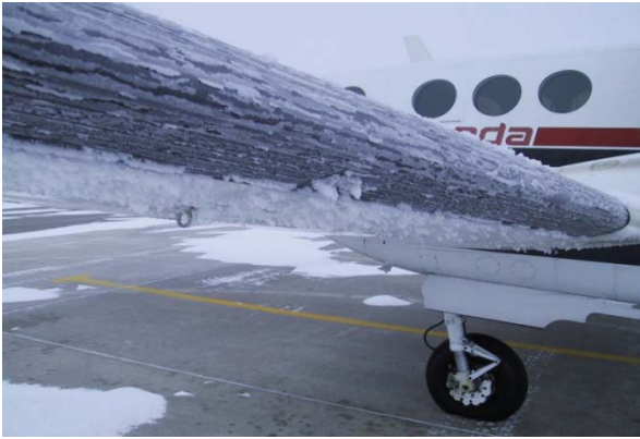
図3 航空機主翼前縁に発生した着氷の状況
