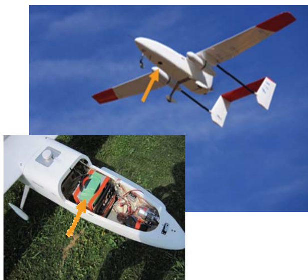
図 9 撮像システムの搭載状況（下）とカメラ孔（上）
