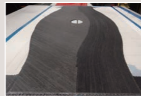
自動積層装置を利用して内部荷重に沿った最適な複合材積層構造を実現
