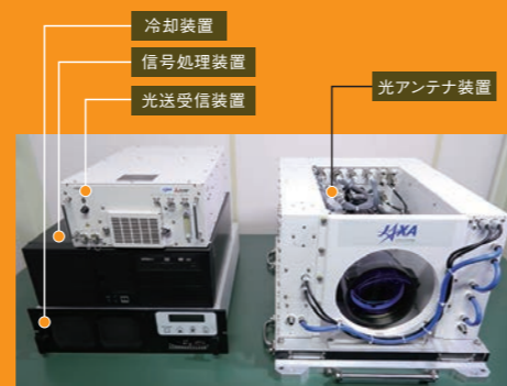
飛行試験に用いた乱気流検知装置
