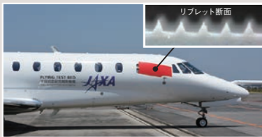
リブレットコーティング技術の飛行実証
