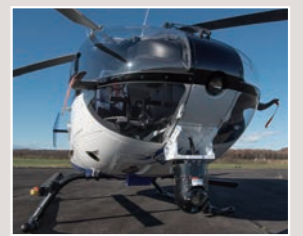
実験用ヘリコプタの機首に搭載されたセンサーポッド
