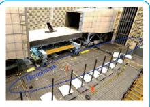
世界有数の大型低騒音風洞(鉄道総研)等を 用いた詳細な低騒音設計の評価
