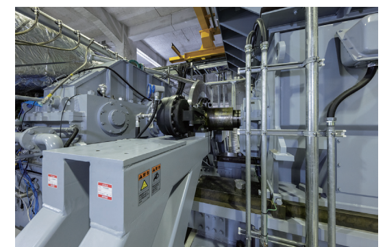
ディスクブレーキ(緊急停止用) Disc brake(for emergency stopping)
