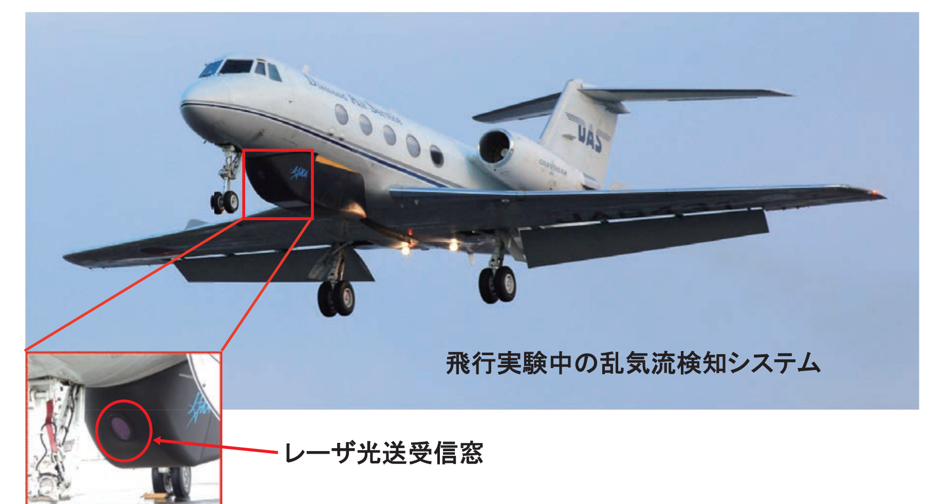
搭載型ドップラーライダーの飛行試験で、乱気流の検知に成功（2010～2013年）
