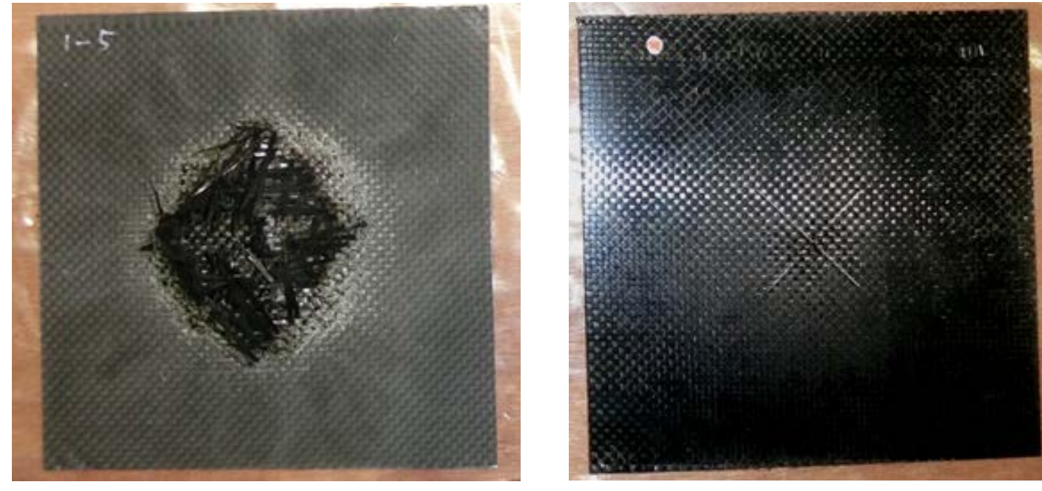
現在の複合材料 耐雷複合材料 模擬雷撃試験結果
