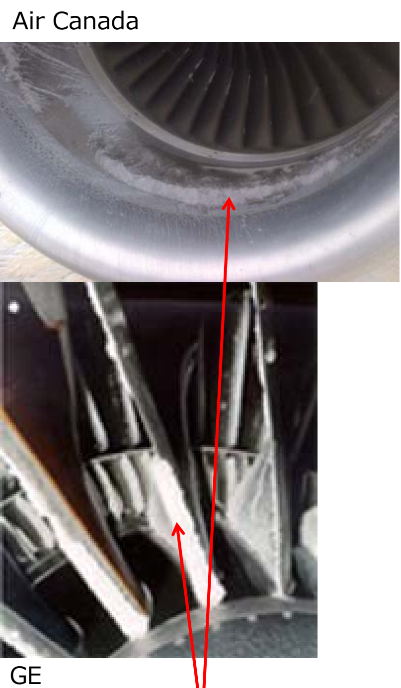
ベース形状 スワイプ形状 三次元翼設計防除氷コンセプト
