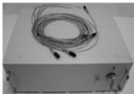
プリアンプ電源装置
