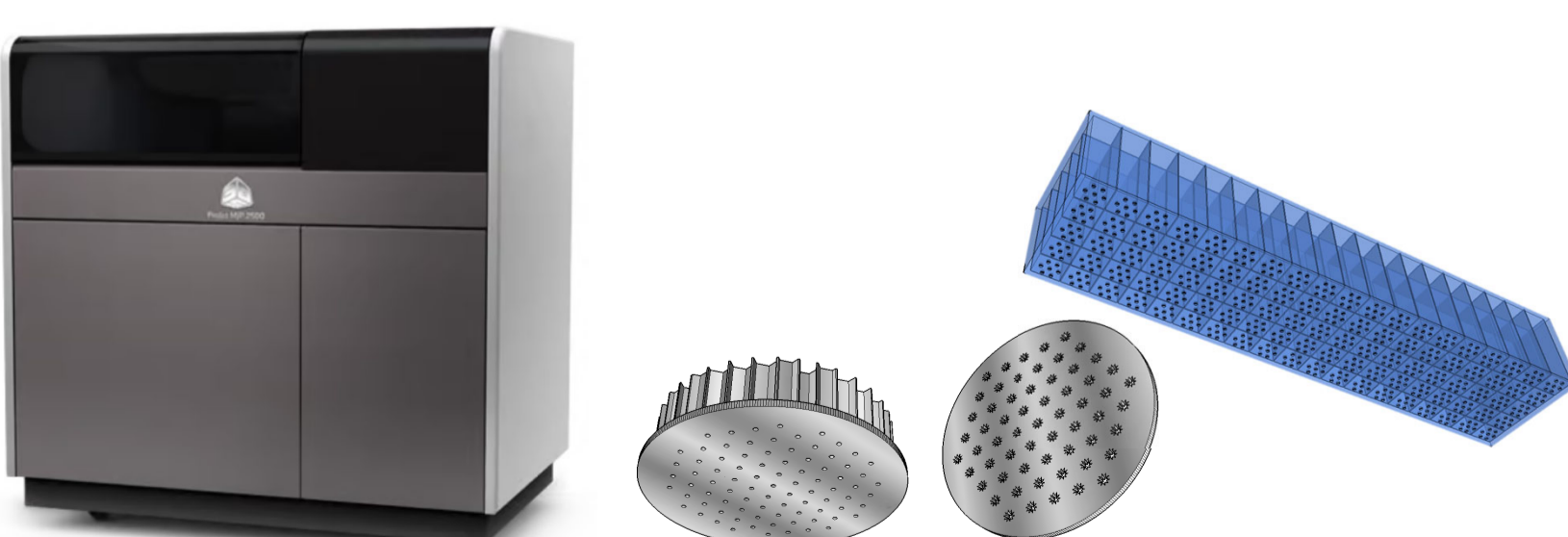
図3.7 3Dプリンタと吸音ライナ供試体
