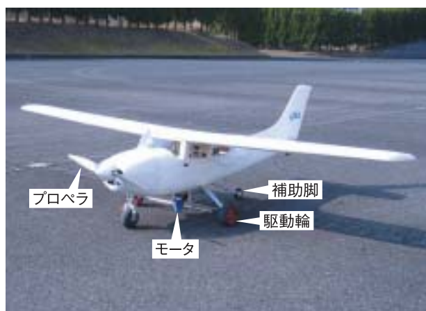
翼幅:2.06m、全長:1.64m 質量:7.85kg(駆動機構搭載前は6.77kg) 離陸速度:50km/h(駆動機構搭載前は47km/h)
