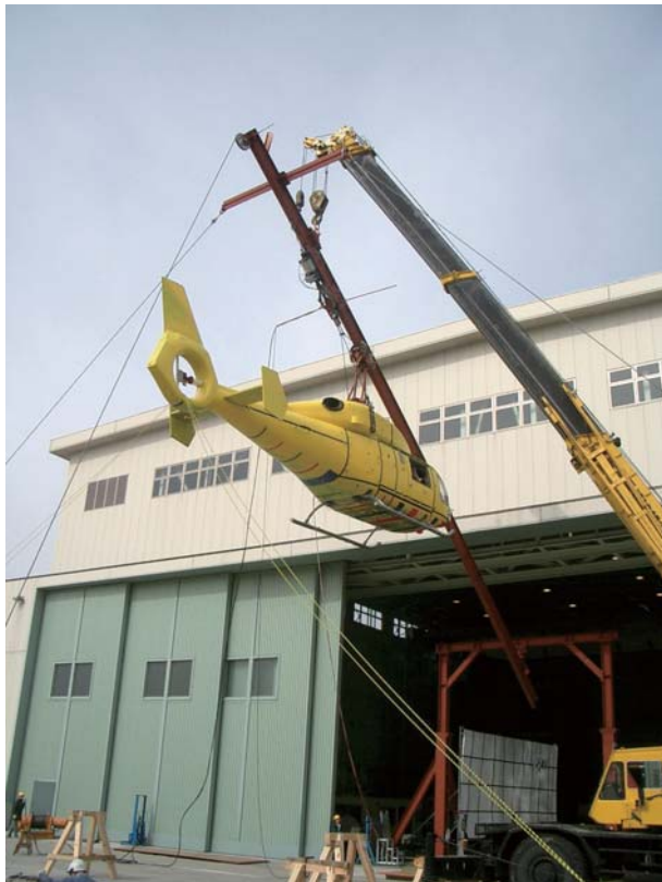
図2 ヘリコプタ実機を使った落下試験と解析図
