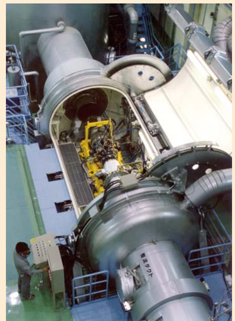
高空性能試験設備。航空機が実際に空を飛んでいる状態を模擬してエンジン運転ができる。
