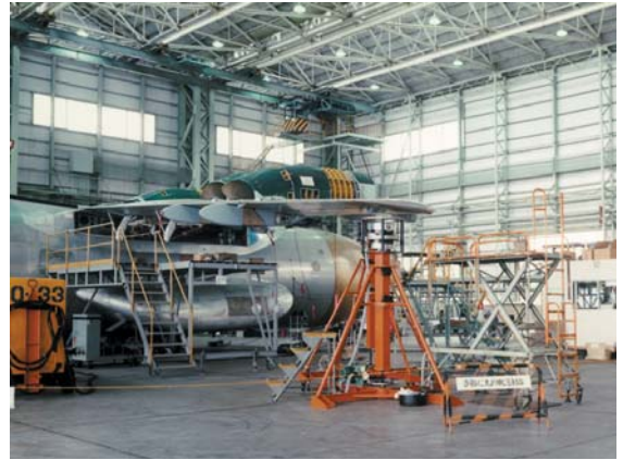
飛鳥全機地上振動試験（予備試験）
