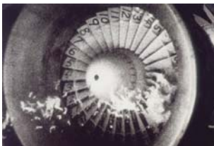
エンジン鳥吸い込み試験
