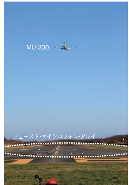
図3 滑走路上に置かれたフェーズドアレイ上空を通過する小型ジェット機MU-300
