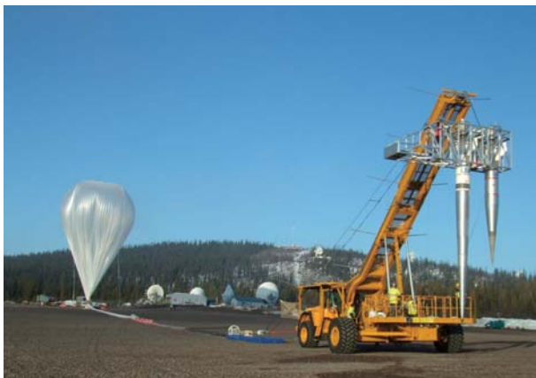
放球準備中。クレーン車に吊るされているのが供試体。左が低ブーム波形モデル、右がN型波形モデル
