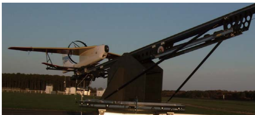
図1 災害監視無人航空機 (右)カタパルトで発射準備中
