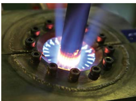
図1 耐熱材料の熱サイクル評価試験
