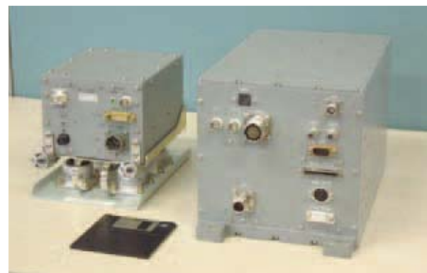
図1 ● JAXAが開発したGPS/INS複合航法システム「GAIA」(無人機用) GAIA技術をもとに当研究開発では旅客機適用をめざす
