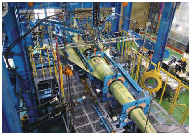
図2 全機構造強度試験のセットアップ状況
