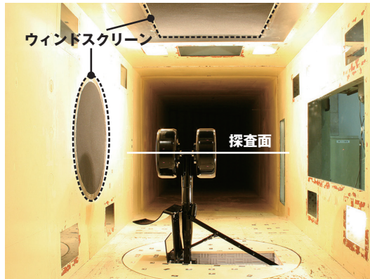
音源探査結果 (音圧分布) (図4) 主脚の40%スケールモデルの風洞騒音計測
