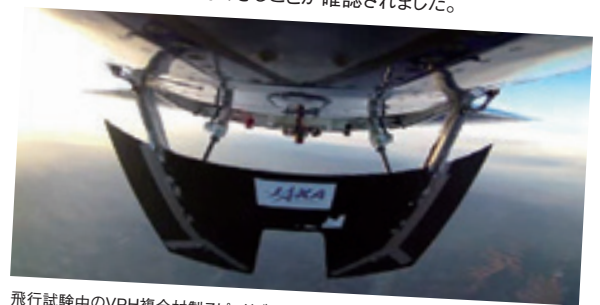
飛行試験中のVPH複合材製スピードブレーキ
