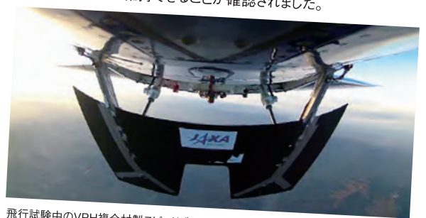
飛行試験中のVPH複合材製スピードブレーキ
