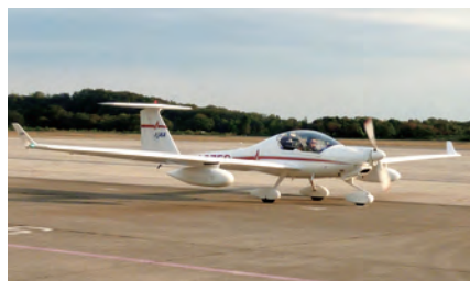
飛行試験を行う予定のモーターグライダー(原型機)
