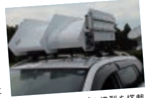
クーラーフラップの模型を搭載した車両。筑波宇宙センター内で予備走行した。
