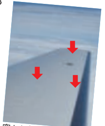
窓から主翼上のターゲットマーカーの位置を撮影
