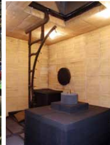
騒音試験設備 騒音源や騒音低減デバイスの効果、騒音の伝播状況の確認などの試験を行う。
