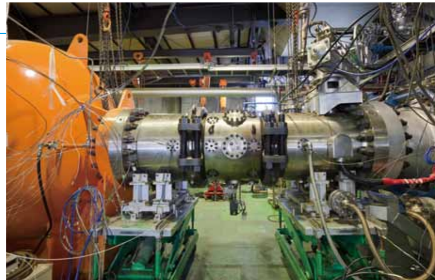
高温高圧燃焼試験設備 ジェットエンジン燃焼器の部分モデルの試験を行う。
