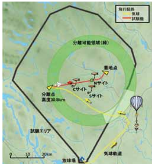
実際の飛行経路。気球は黄色い線を辿って移動した。試験機は、高度30.5kmの分離可能なドーナツ領域内で分離され、赤い線の経路を辿りながら、BMSサイトの一つであるNサイト上空を通過して着地した。
