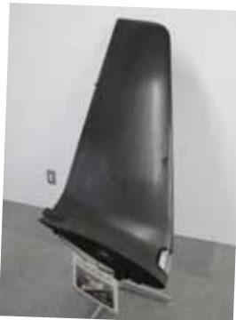
リサイクルCFRP技術で作られた実物大ウィングレットの模型
