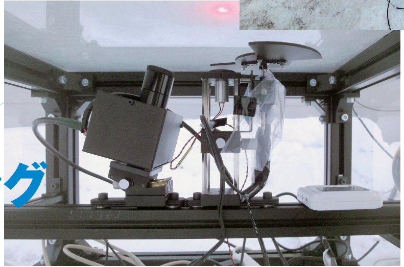
雪に当たった散乱光の広がりや強さから、雪氷の厚さや雪質を検知した。
