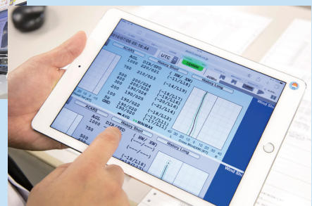
フライト前のディスパッチルームでは、機長と副操縦士が飛行空域の気象予測などさまざまな情報を用いて、綿密に飛行計画を確認する。JAXAと気象庁が共同研究した「空港低層風情報(ALWIN: Airport Low-level Wind INformation)」は、すでに実用化段階にありフリーフィング資料として活用され始めている。(ALWINについては、FLIGHT PATH No.8を参照)
