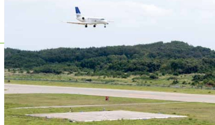
騒音源計測のためにマイクロホン・フェーズドアレイ(p6参照)の上を低空飛行する「飛翔」
