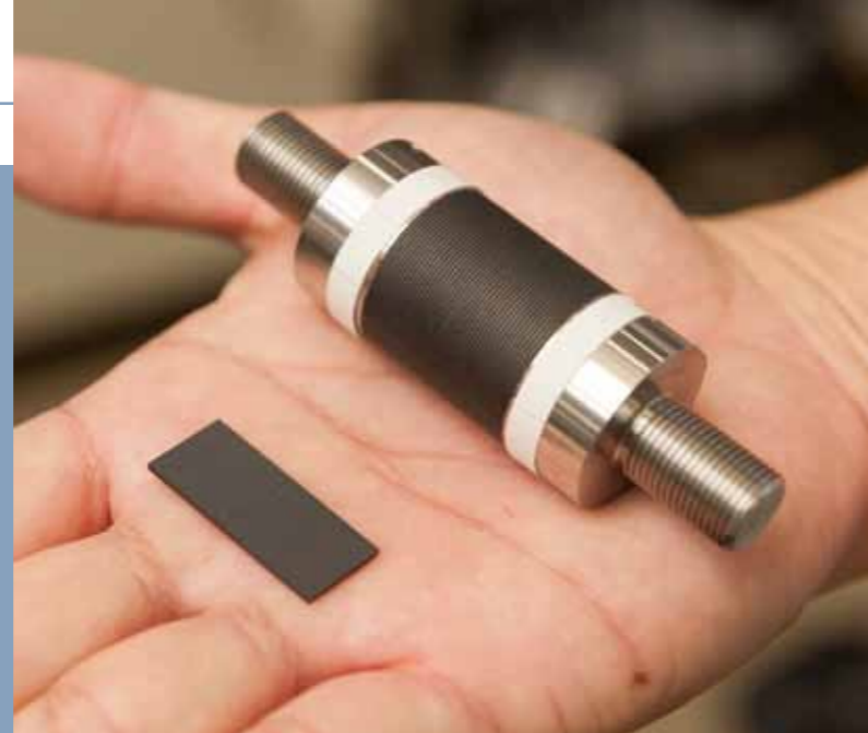
現在の評価試験で用いられる試験片(奥)とJAXAが提案している新試験方法で用いられる試験片(手前)。
