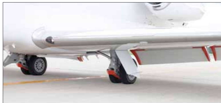
低騒音化の改造を行った「飛翔」のフラップと脚。赤い部分が改造された箇所。
