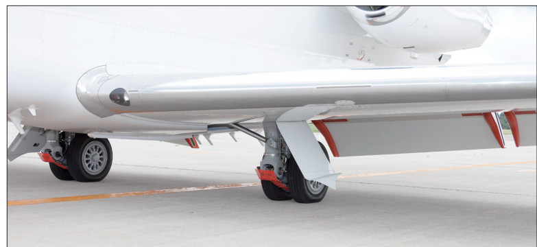
低騒音化の改造を行った「飛翔」のフラップと脚。赤い部分が改造された箇所。
