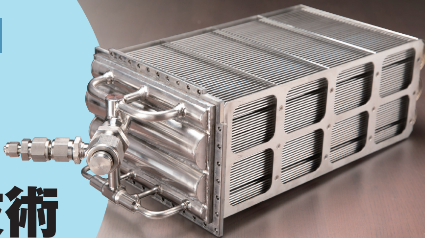
JAXAで研究中の極超音速予冷ターボジェットに使われている熱交換器。伝熱管部分は、温度差による部材の変形も考慮した形状になっている。
