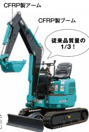
CFRP製の軽量アームおよびブームを装着した1tクラス油圧ショベル(地上用) (画像提供:株式会社タグチ工業/JAXA)
