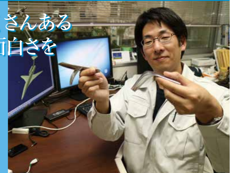
共同研究で製作した主翼の風洞模型。下向きのウイングレットや新しい発想による主翼形状を検討した
