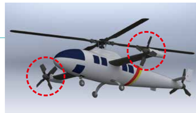
スケールモデルの試験機の試作を予定しているコンパウンドヘリコプター(イメージCG)。主翼の両端に配置された電動ファン(赤色の点線で囲まれた部分)によってトルクを打ち消すとともに、10%程度の推進力も生み出す
