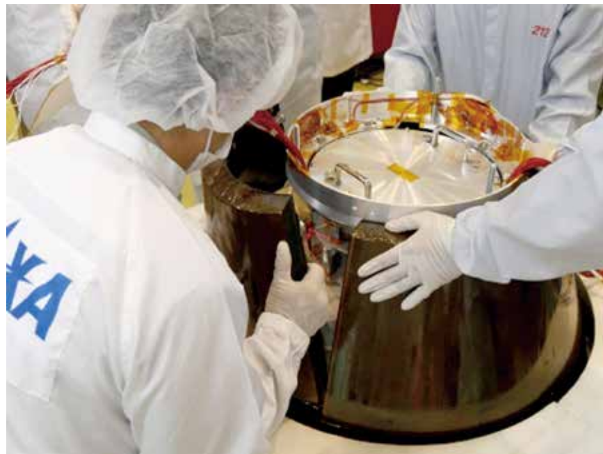
小型回収カプセル 現在開発中の小型回収カプセルの直径は84cm。「このとりの」やISSのハッチを通ることができる。
