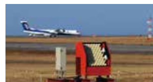
左：大分空港に試験設置した SOLWIN用ソーダーの受信機（手前中央の赤いBOX）、右：SOLWIN がインターネット上で提供する風情報の例（風向・風速、上下風の現在の数値、グラフ（上部）や過去の履歴（下部）を表示）
