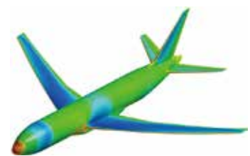
FaSTARで計算した機体表面の圧力分布
