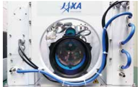
旅客機に搭載可能な小型軽量化を図ったドップラーライダーの試験装置
