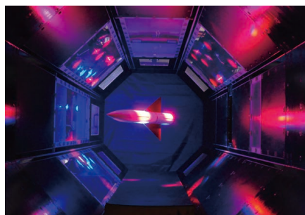
磁気で模型の姿勢を制御する1m直径の磁力支持天秤装置 (画像提供: 東北大学)
