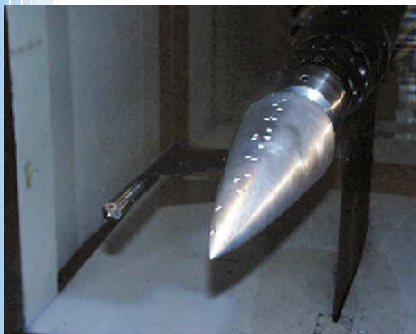
実機プローブと機首部分模型のセットアップ状況
