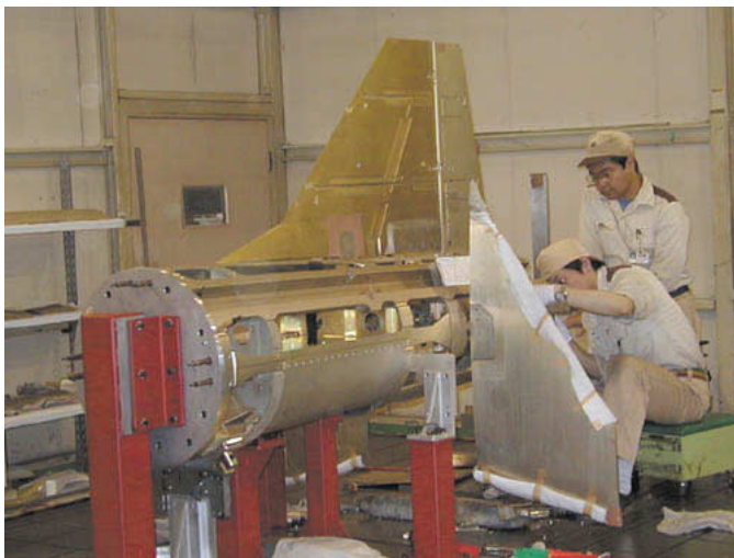
ロケット実験機の機体製作状況
