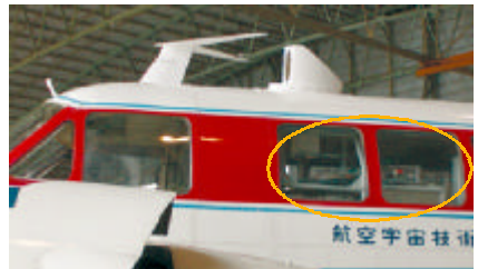
写真2 飛行機に搭載された風計測ライダの様子
