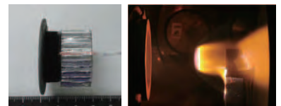
火星探査機や有人宇宙機に必要な材料の開発を進めている（左）再利用可能な超軽量エアロシェル（通称「なると」）の加熱試験用模型（右）加熱試験の様子
