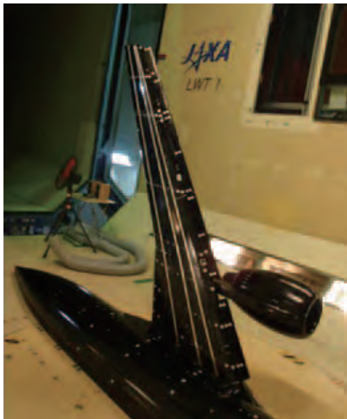
図2 翼模型に対する光ファイバセンサーひずみ計測試験
