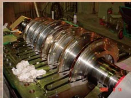
10000 kW 高压空気圧縮機
