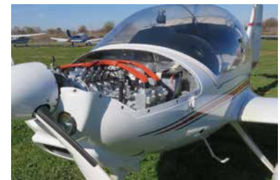
試験機に実装された電動推進システム (2015年) Electric propulsion system
