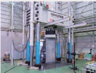
炭素繊維強化プラスチック (CFRP) パネルの圧縮試験
