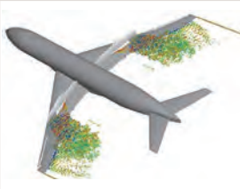
非定常流体ソルバによるバフエット発生時の流れ場解析
