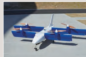
ティルトウイングVTOL無人機(JAXA技術を適用した静岡県の実用実証機)
