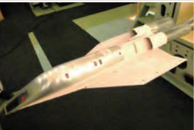
感圧塗料 (PSP) による超音速インテーク模型表面の圧力測定
