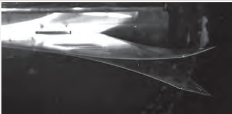
気流による翼の振動現象 (フラッタ) の試験
