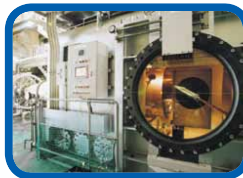
ロケットなどで宇宙に行って、 地球に帰ってくる乗り物を 試験する“極超音速風洞”
