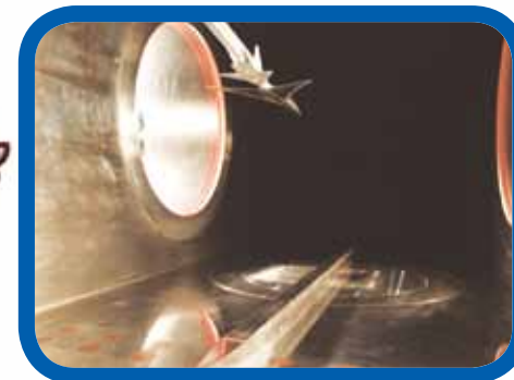
音よりも速い飛行機を 試験する“超音速風洞”
