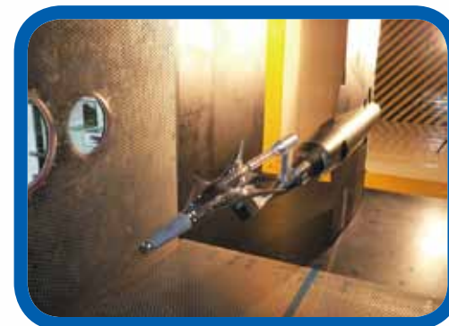
飛行機が空を飛んでいる状態を 試験する“遷音速風洞”
