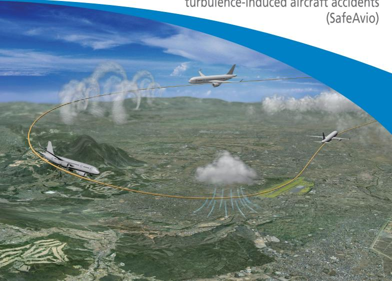
JAXAでは、ドップラーライダー (LIDAR: Light Detection and Ranging) により乱気流を事前に検知し、機体の揺れを自動的に低減制御することで乗客・乗員の安全性を向上するための世界初のシステム実現に向け、「乱気流事故防止機体技術 (SafeAvio)」の研究開発を行っています。
