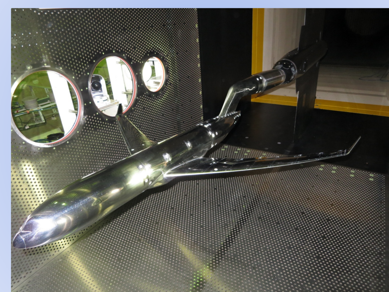
主翼の翼端につけて抵抗を低減するデバイスの開発
