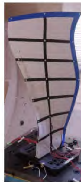
試験後(軽微な損傷のみ)
