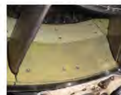
吸音ライナ試作モデル (樹脂製ハニカム構造)
