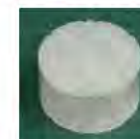
吸音ライナ試作モデル (樹脂製ハニカム構造)
