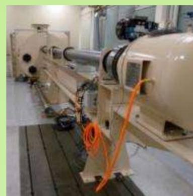
耐衝撃性実証試験(高速衝撃試験機)
