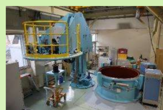
耐久性実証試験(回転強度試験機)
