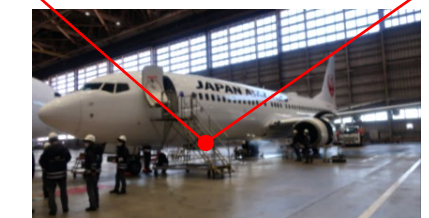
JAL B737-800型機の胴体下部にリブレットを施工
