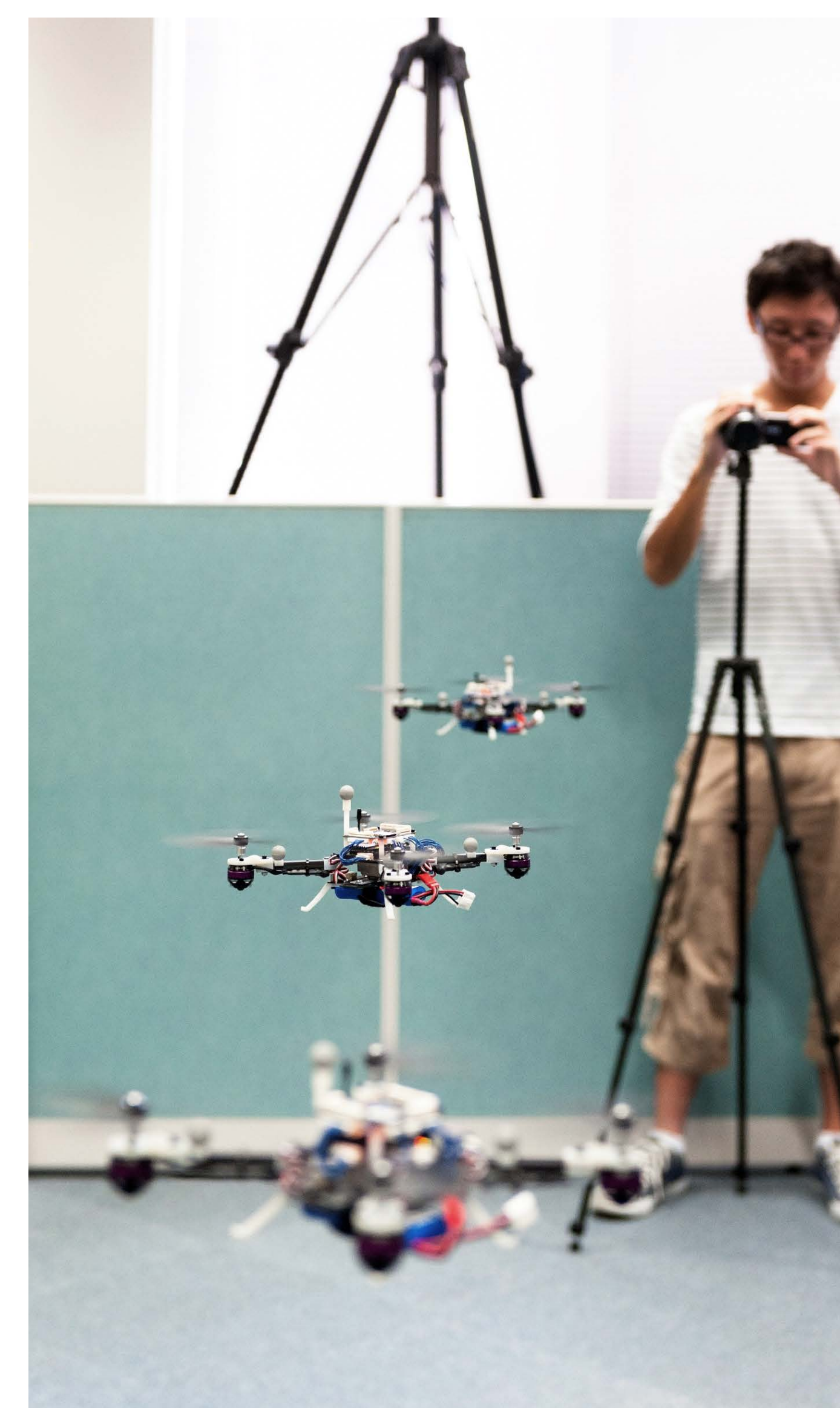
図3. MAVの複数飛行 (現状では、機体外部からの位置計測(モーションキャプチャ)情報を利用した飛行)
