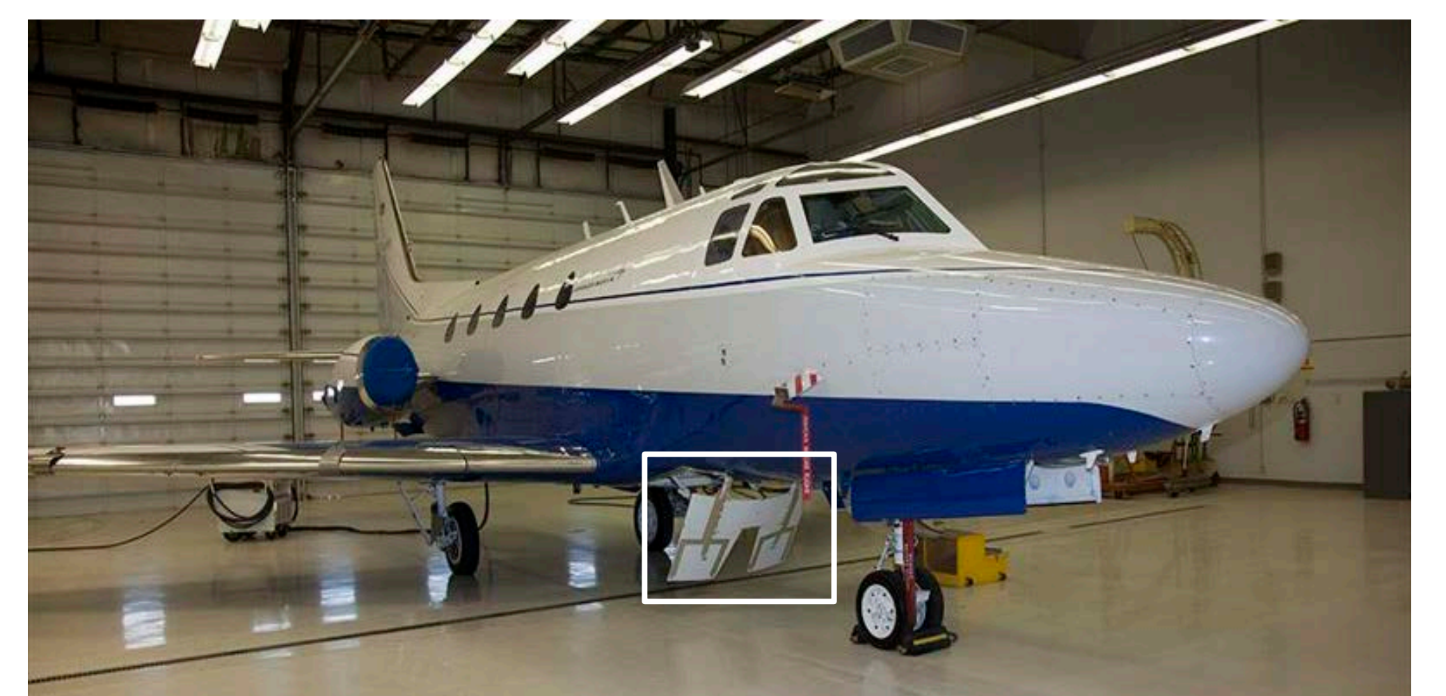
使用したジェット機(Sabreliner 65) (スピードブレーキ(白線内)を開いたところ)
